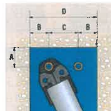
Espace libre requis pour le sertissage des manchons avec diamètres de 12 à 35 mm.
